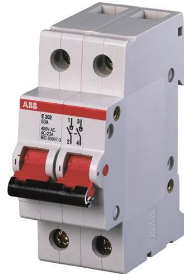
Эти устройства подходят для начальствующего нагрузки и они реализуются согласно EN 60947-3 и EN 60669-1 соответственно. Быстрое удаление без демонтажа шины. Невыпадающие винты с утопленными/шлицевая головка. Размер Pozidrive 2. Надстройка до 3 вспомогательных контактов S2C-H6R интегрированным надеваемые края для маркировки системы ILS. Запирающее устройство в качестве аксессуаров для несанкционированного включения/выключения. Утверждения: VDE, КХЦ, КЕМА
