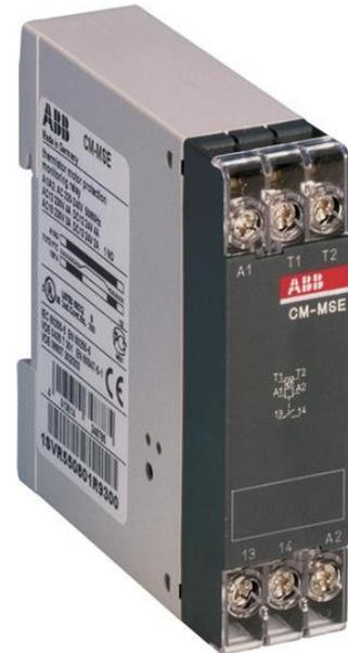
См-ОГЭ реле с реле защиты см термистора двигателя. Это реле работает с Номинальное напряжение питания 24 В переменного тока и 1 н/о контакт выхода на Номинальный 250 В / 4 А. он имеет одну цепь датчика для мониторинга температурных датчиков РТС или биметаллов. Это реле обеспечивает автоматическую перезагрузку и работает по принципу замкнутого контура. Герметичный прозрачный чехол для защиты от несанкционированных изменений доступен как аксессуар
