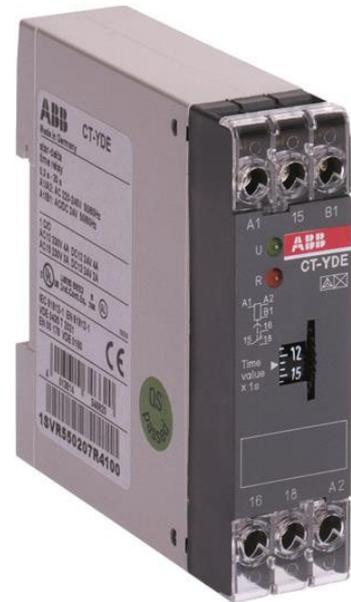
КТ-ЙДЕ одиночн-функции электронных реле времени с КТ-е диапазон таймера. Это обеспечивает функция звезда-треугольник с диапазоном времени от 3 С до 300 с. На этот раз реле работает с Номинальное напряжение питания 24 В переменного тока / постоянного тока / 220 - 240 В переменного тока и 1 ч/з (однополюсный на два направления) выходной мощностью 250 В / 4 А.
