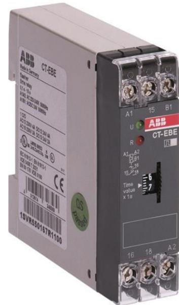
КТ-ЭБЭ является одной функции электронных реле времени с КТ-е диапазон таймера. Она обеспечивает мигалкой (обработка равные промежутки времени) функция с временным диапазоном от 0.1 до 10 сек. На этот раз реле работает с Номинальное напряжение цепей управления 110 в - 130 В переменного тока и 1 ч/з (однополюсный двухпозиционный) выход на Номинальный 250 В / 4 А.
