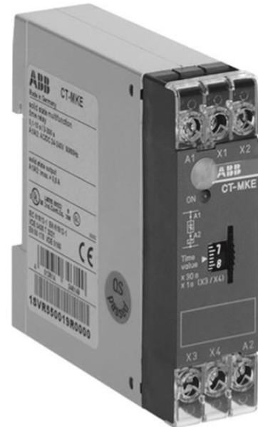
КТ-МКЕ-это многофункциональное электронное реле времени с КТ-е диапазон таймера. Она обеспечивает 4 функции синхронизации с 2 диапазонов времени от 0,1 С до 300 с. На этот раз реле работает с Номинальное напряжение питания 24 - 240 В переменного тока / постоянного тока и твердотельным выходом.
