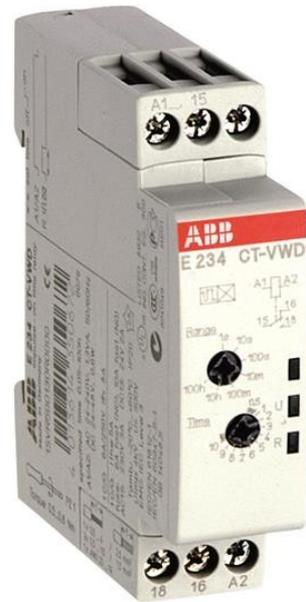
КТ-БВ.12 одиночн-функции электронных реле времени с ТТ-д диапазон таймера. Он дает импульс-на (интервал) функция с 7 диапазонами времени от 0,05 С до 100 ч. На этот раз реле работает с номинальным управления Напряжение питания 24 - 48 В DC / 24 - 240 В переменного тока и 1 ч/з (однополюсный двухпозиционный) выход на Номинальный 250 В / 6 А.
