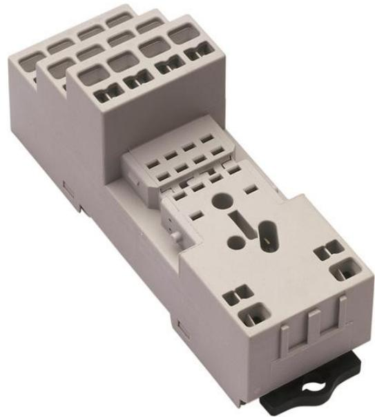
CR-M2LC сокет от КАД-М (миниатюра) реле диапазона. Логическая розетка подходит для CR-M реле с 2 C/O (однополюсный на два направления) выходные контакты. Гнездо имеет пружинные клеммы подключения. Подключаемые модули функции, держатель и маркер доступны в качестве аксессуаров.
