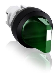
Модульный переключатель - 3-поз поддерживается/Сиюминутную, а и В фиксированы, с пружинным возвратом от С к В - Короткая ручка - зеленый - подсветкой - черный пластик - нет контакта блок
