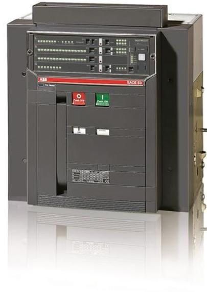
Итальянское sace EMAX выключателя E3H 1000A TP-полюса закреплены с задней горизонтальной расцепитель PR121/P-ЛСИ P1000 установлены: 4 вспомогательный контакт и С. выключатель в положение открыто-закрыто
