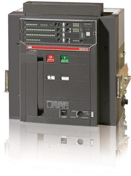
Итальянское *sace* EMAX подвижной части для выключателя E3H 2000A TP-полюса, расцепитель PR121/P-ЛСИ r2000 с оборудованы: 4 вспомогательный контакт и С. выключатель в положение открыто-закрыто
