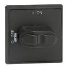
Тип селектора ручка, Индикация я-О И НА -, для валов диаметром 6 мм, сверлить дверь 22.5 мм. ИС 54 ручка, Блокировка дверцы в позиции, НЭМА 1, черный, 80F OT16...
