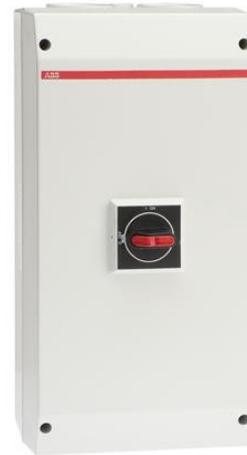
Закрытый выключатель 3-п.Пластиковый корпус 125А 400В АС22А АС23А 50А
