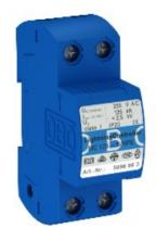
MC 125-B/NPE: Para uso em TN-S e TT sistemas de N-PE gap de descarga, tipo 1 (Classe B) IEC 61643, para interface de 0 a 1 (LPZ) de acordo com o conceito de zonas de proteção contra raios IEC 61312-1 e/ou DIN V VDE V 0185 Parte 4 para usar o descarga diferença entre o N e o PE.
