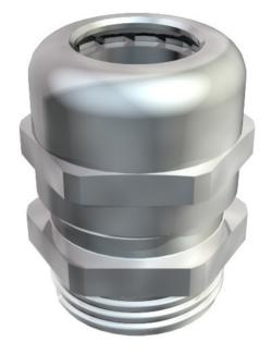
Com métrica rosca de conexão IEC 423, robusto cap-porca roscada de cabos com grande área de vedação. Alívio de tensão, torcendo proteção e aperto sobre toda a área de fixação. Neoprene anel de vedação. Poliamida terminal inserir. Com a prémontado O anel de vedação na conexão com rosca, VDE-testado com a norma DIN EN 50262, grau de proteção IP68 em 5 bar para 1 hora, máx. permitida temperatura ambiente de -20 a 100°C.
