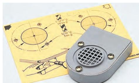
**Descrição:** É necessários instalar dois respiradores por armário para garantir a circulação de ar e impedir a condensação de água. Os respiradores devem ser montados preferencialmente na parte superior e inferior do armário. Grau de protecção: IP 44.
