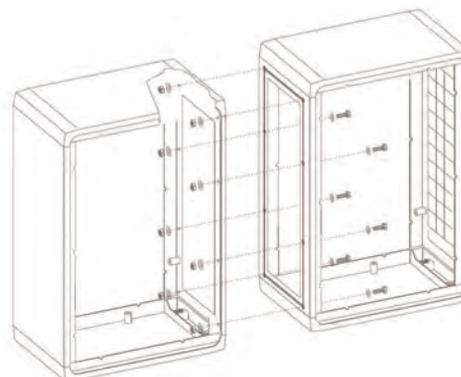
**Descrição:** O kit permite a união vertical e/ou lateral de armários. A sua aplicação requer a utilização de ferramentas mecânicas
