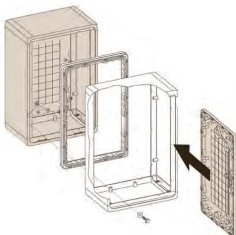
**Descrição:** Permite aumentar a profundidade standard de 320mm para 640mm. A utilização deste acessório impede a utilização do tejadilho.
