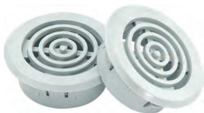
**Descrição:** Para a ventilação do armário, invisível se a montar na parede interior do canto com parede dupla. A sua aplicação requer a utilização de ferramentas mecânicas (furação com 34.9mm de diâmetro).
