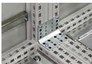
**Descrição:** Estes suportes rígidos proporcionam um reforço adicional em armários combinados, completamente equipados e que tem a necessidade de serem elevados e/ou transportados. Podem ser usados com as platinas de separação SPD
