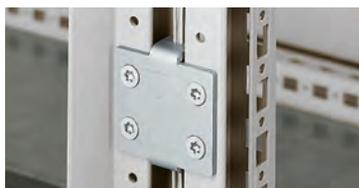
**Descrição:** Suportes montados nas furações exteriores da estrutura do armário, garantindo assim uma forte união nos armários nas 3 dimensões com a função de "auto-espaçamento". Este sistema de união de armários tem a vantagem de incluir uma ligação directa à terra entre as estruturas dos armários.
