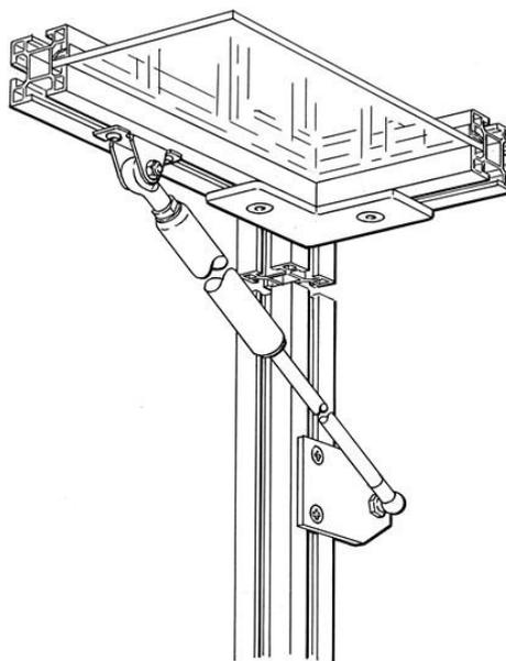
A mola de gás, incluindo as ferragens, comprimento 350 mm, Especifique a força necessária ao fazer o pedido.
