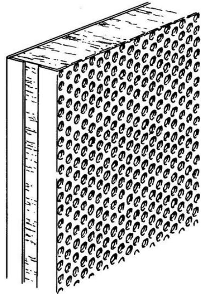
Absorção do som no painel de 25 mm liso (branco poliéster)/perfurado (galvanizado), o material do Núcleo é a lã Mineral, redução Sonora de 29dB Rw. Dimensão 1963x1200mm.
