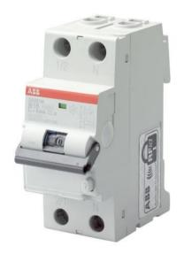
O DS201 série RCBO é um 1P+N em dois módulos dispositivo para a proteção do usuário final de fase única de circuitos contra sobrecarga e correntes de curtocircuito; proteção contra os efeitos do senoidal alternada e direta pulsante terra, as correntes de falta; a proteção contra contatos indiretos e adicionais de proteção contra contatos diretos (com sensibilidade = 30 mA).
