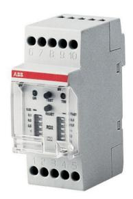
Corrente Residual monitores (Rcm) com transformador externo pode detectar correntes de fuga. Através minidip você pode definir a sensibilidade e a intervenção do tempo. De acordo com o mesmo diâmetro, transformadores são feitas em uma única versão para todos os relay valores de sensibilidade.
