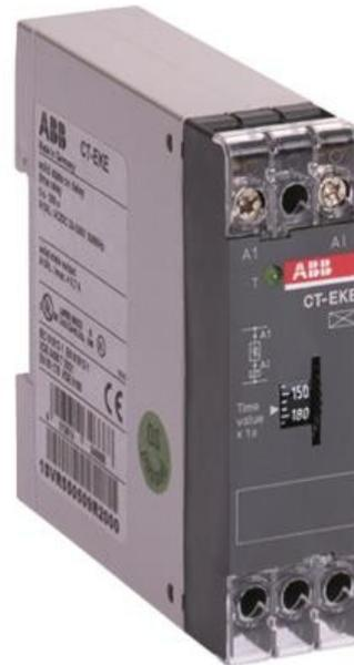
O CT-EKE é uma única função de relé de tempo eletrônico do CT-E temporizador de intervalo. Ele fornece um delay (atraso) de função com um intervalo de tempo de 0,1 s para 10 s. Desta vez relé opera com uma taxa de controle de tensão de alimentação de 24 - 240 V AC / DC e tem uma saída de estado sólido.
