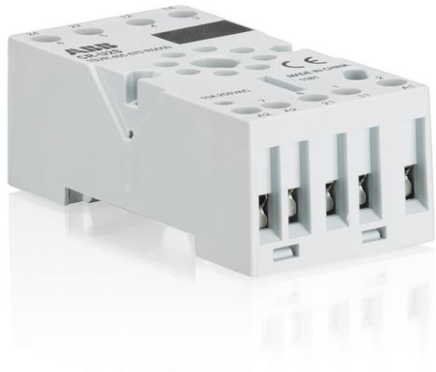
O CR-U2S é tomada a partir do CR-U (universal) relé de intervalo. O soquete é apropriado para o CR-U relés com 2 a/c (SPDT) contatos de saída. O soquete tem parafuso bornes de ligação. Pluggable módulos de função, titular e marcador estão disponíveis como acessórios
