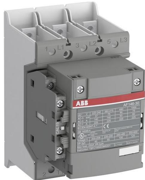
3-fase de Contactor adequado para várias aplicações, tais como o Motor de partida, o Isolamento, o By-pass e de Distribuição de aplicativo, até ao máximo de 1000 V. Operado com o controle de toda a faixa de tensão de 24-60 V, 50 e 60 Hz, 20-60 V DC
