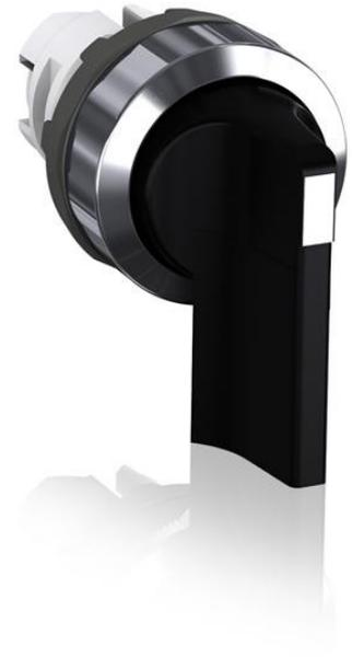
Modular chave Seletora - 3-Pos Mantido/Momentânea, A e B fixo, com retorno de mola e de C para B - cabo Longo - Preto - Não-iluminado - plástico Cromado - Sem bloco de contatos
