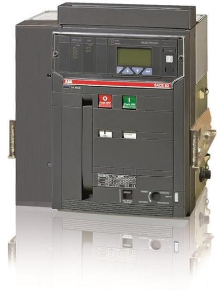
SACE EMAX PARTE móvel PARA DISJUNTOR E2S 1250A de QUATRO PÓLOS de SOBRECORRENTE de LANÇAMENTO PR122/P-LI R1250 EQUIPADO COM: 4 de contatos AUXILIARES E C. DISJUNTOR NA POSIÇÃO de ABERTO-FECHADO
