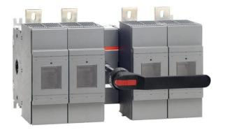
Incluindo o terminal de parafuso kit, um preto ON-OFF com cabo de plástico e veio como padrão. O identificador é IP65, NEMA 1, 3R, 12 protegido, trava com cadeado FORA de posição e com intertravamento da porta na posição. O eixo é ajustável para um intervalo de profundidade da instalação. Fusível normas UL 248.
