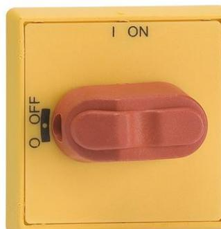
Seletor tipo punho, a Indicação I-S e ON-OFF, para o eixo de diâmetro de 6 mm, porta de perfuração de 22,5 mm. IP 54 punho, NEMA 1, vermelho-amarelo, OT16...80F
