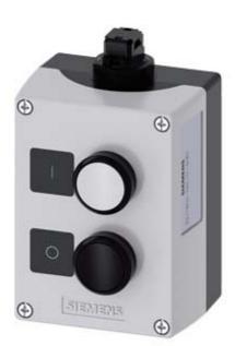
Корпус с AS-интерфейсом командных устройств, 22 мм, кругл., материал корпуса: пластмасса, верхняя часть корпуса, цвет: серый, 2 командных пункта, пластмасса, углубление для шильдиков, В = кнопочный выключатель, цвет: белый, Табличка: I, 1 HO, подключение на пружинных клеммах: A = кнопочный выключатель, цвет: черный, шильдик: О 1 НЗ, подключение на пружинных клеммах: монтаж на полу, прорезание изоляции сверху, Шильдики прилагаются
