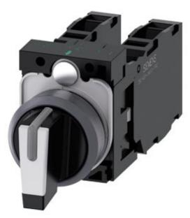
тумблер, с подсветкой, 22 мм, кругл., пластмасса с металлическим фронтальным кольцом, цвет: белый, рычаг, короткий, 3 положения переключателя I>O<II, нажатием на кнопку, угол переключения 2 х 45°, 10:30 ч/12 ч/13:30 ч, с держателем, 1 HO + 1 H3, 1 HO + 1 H3, винтовой зажим
