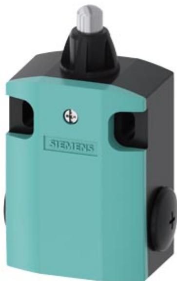
Позиционный выключатель Металлический корпус шириной 56 мм Подключение устройства 3 x (M20 x 1,5) 1 NO/1 НЗ, контакты мгновенного действия Закругленный плунжер, с перебогом 3 мм из нержавеющей стали Усилие для приведения в действие/возвращающее усилие 30 Н, поставляется только как комбинированное устройство
