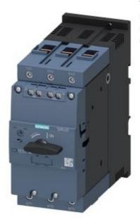
Автоматический выключатель, типоразмер S3 для защиты двигателя, класс срабатывания 10 Максимальный расцепитель тока с обратнозависимой выдержкой времени 36–50 A N-расцепитель 650 A Винтовой зажим Стандартная коммутационная способность с поперечным выключателем вспомогательных цепей 1 HO + 1 H3
