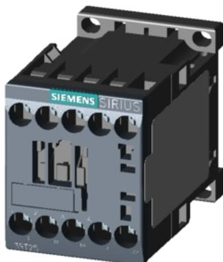
Контактор, 2 НО + 2 НЗ, AC-3, 5,5 кВт, 110 В AC, 50 Гц, 120 В, 60 Гц, 4-полюсн., 2 НО + 2 НЗ, типоразмер S00, винтовой зажим
