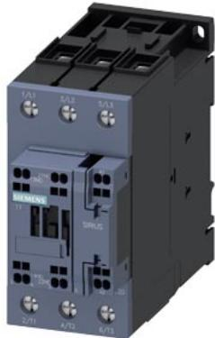
Силовой контактор, AC-3 80 A, 37 кВт/400 В 1 НО + 1 НЗ, 24 В DC с варистором 3-полюс., типоразмер S2 Пружинная клемма подходит для выходов ПЛК 2 А
