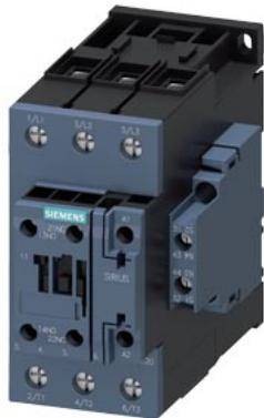
Силовой контактор, AC-3 65 A, 30 кВт/400 В 2 НО + 2 НЗ, AC/DC 20–33 В, с варистором 3-полюсн., типоразмер S2 винтовой зажим боковой блок дополнительных контактов
