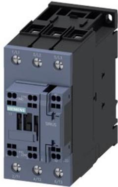
контактор, AC-3 51 A, 22 кВт/ 400 В 1 HO + 1 H3, 20-33 В AC/DC 3-пол., типоразмер S2, пружинные клеммы
