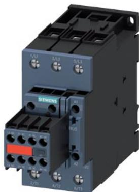
Силовой контактор, AC-3 40 A, 18,5 кВт/400 В 2 НО + 2 НЗ, 24 В DC с варистором, 3-полюсн., типоразмер S2, винтовой зажим выключатель вспомогательных цепей, неразъемный подходит для выходов ПЛК 2 А
