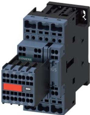
Силовой контактор, AC-3 38 A, 18,5 кВт/400 В 2 НО + 2 НЗ, 230 В AC 50/60 Гц, с установленным варистором 3-пол., типоразмер S0 пружинная клемма несъемный вспомогательный выключатель
