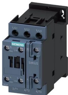
Силовой контактор, AC-3 25 A, 11 кВт/400 В 1 НО + 1 НЗ, 208 В AC, 50/60 Гц, 3-полюсн., типоразмер S0, винтовой зажим
