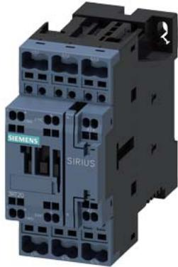
Силовой контактор, AC-3 17 A, 7,5 кВт/400 В 1 HO + 1 H3, AC (50–60 Гц) режим работы по постоянному току 21–28 В AC/DC, 3-полюсн., типоразмер S0, пружинная клемма
