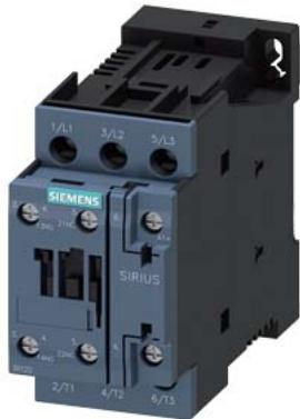
Силовой контактор, AC-3 17 A, 7,5 кВт/400 В 1 НО + 1 НЗ, 24 В DC со вставленной комбинацией диодов, 3-полюсн., типоразмер S0, винтовой зажим
