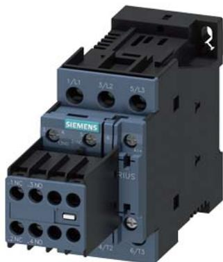
Силовой контактор, AC-3 12 A, 5,5 кВт/400 В 2 НО + 2 НЗ, 24 В DC 3-полюсн., типоразмер S0, винтовой зажим Выключатель вспомогательных цепей, разъемный
