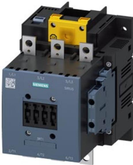
Силовой контактор, AC-3 115 A, 55 кВт/400 В Катушка 50/60 Гц AC и 96–127 В DC x (0,8–1,1) Вход F-ПЛК 24 В DC 3-полюсн., типоразмер S6, Вспомогательные контакты 2 НО + 2 НЗ Главная цепь: шина Цепь управления и вспомогательная цепь: винтовой зажим
