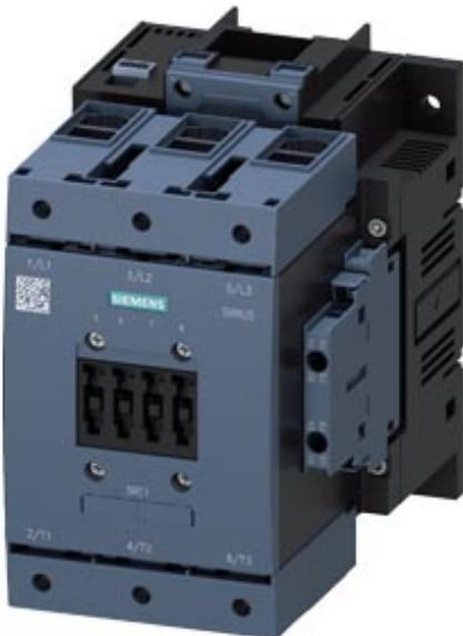
Силовой контактор, AC-3 115 A, 55 кВт/400 В AC (50–60 Гц)/режим работы по DC UC 21–27,3 В Вспомогательные контакты 2 НО + 2 НЗ 3-полюсн., типоразмер S6, с рамочными клеммами Привод: электронный с интерфейсом ПЛК 24 В DC винтовой зажим
