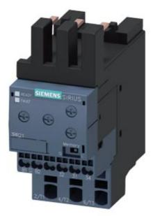
Реле контроля, установка на контактор 3RT2, типоразмер S0 Basic, аналоговая регулировка Мониторинг кажущегося тока 4–40 A, 50–60 Гц, 2-фазн. Питание 24 В АС/DС 1 переключающий контакт Контроль на Превышение и недостижение Выпадение фазы Обрыв провода контроль рампы торможения (с или без датчика) Задержка пуска 0–60 с Отфильтровывание импульсных помех 0–30 с Гистерезис срабатывания 6 % Пружинные клеммы
