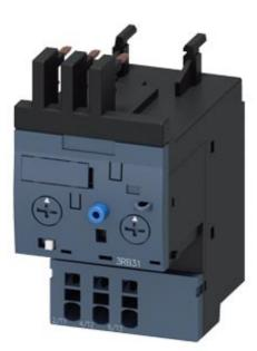
Реле перегрузки 0,1–0,4 А электронн. для защиты двигателя Типоразмер S00, класс 5–30 Для установки на контакторах Главная цепь: пружинная клемма Вспомогательная цепь: пружинная клемма Ручной/автоматический сброс Внутреннее обнаружение замыкания на землю
