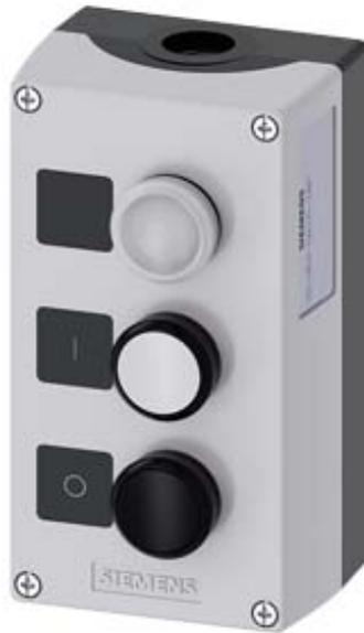
caixa para aparelhos de comando, 22 mm, redondo, material da caixa de plástico; parte superior da caixa cinza, 3 posições de comando de plástico, C=indicador luminoso transparente, placa, LED 24 V, conexão parafusada, B=botão branco, placa: I, 1NA, conexão parafusada, A=botão preto, placa: O, 1NF, conexão parafusada, fixação no piso, em cima e embaixo para cada 1xM20, placa incluída
