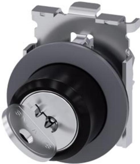
interruptor de chave RONIS, 30 mm, redondo, metal, mate, anel frontal para montagem plana, número do fecho SB30, com 2 chaves, 2 posições de comutação O-I, de encaixe, Ângulo de comutação 90°, 10:30h/13:30h, retirada da chave I, fechos especiais possíveis: SB31, 421, 455
