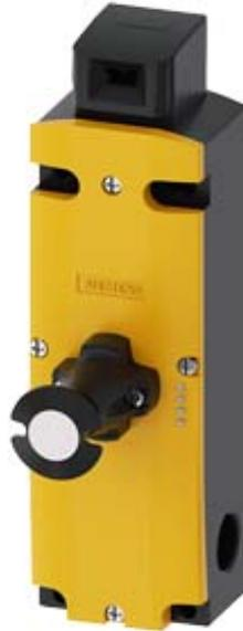
chave de posição de segurança com dispositivo de retenção torque de aperto 1300 N 5 direções de arranque grau elevado de proteção IP69, IEC 60529 carcaça de plástico, 3x(M20x1,5) força da mola travada desbloqueio de fuga de frente tensão magnética 24 V CC motonitoramento do atuador 2NF/1NA motonitoramento do imã 2NF/1NA indicação LED amarelo/verde entrega sem atuador atuador 3SE5000-0AV0. encomendar separadamente parafusamento de cabo IP69 utilizar
