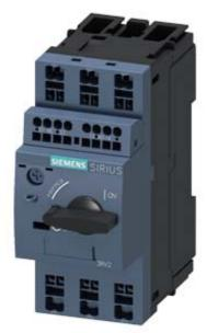
disjuntor tamanho S00 para a proteção de motor, classe 10 disparador A 1,1...1,6 A disparador N 21 A conexão de mola capacidade de comutação com interruptor auxiliar em posição transversal 1NA+1NF
