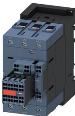
Contator de potência, CA-3 110 A, 55 kW / 400 V 2 NA + 2 NF, 20-33 V CA/CC de 3 polos, 3NA, tamanho S3 conexão de mola varistor integrado interruptor auxiliar não removível
